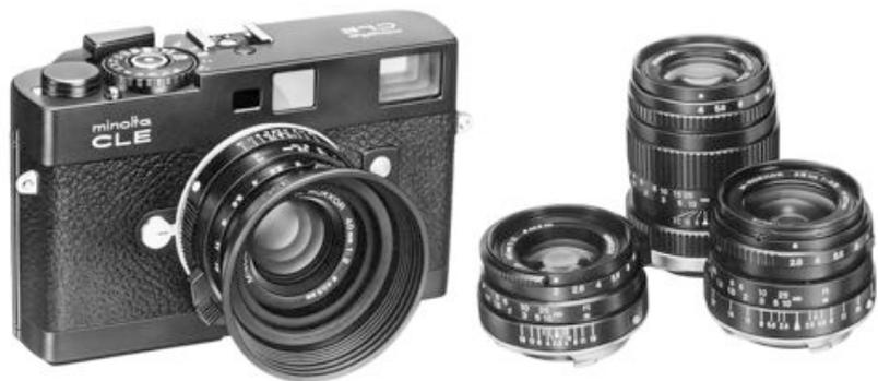
1980年発売されたミノルタCLE (Minolta CLE) (コンパクトライカ・エレクトロニック) (Compact Leica Electronic) は、ミノルタがライカCLをベースに開発したコンパクトなレンジファインダーカメラで、交換レンズと、画期的な自動露出を装備していた。右はCLE用に別途設計されたミノルタMロッキール (Minolta M-Rokkor) 2/40 mm、4/90 mmおよび 2,8/28 mm。
